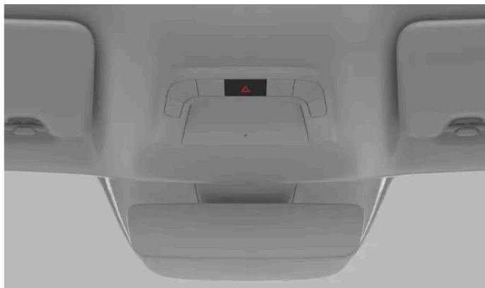
Varoitusvilkkujen painikkeen sijainti kattokonsolissa.
