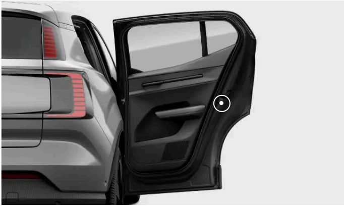
Lapsilukon kytkimen sijainti.
