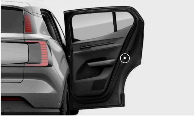
Lapsilukon kytkimen sijainti.
