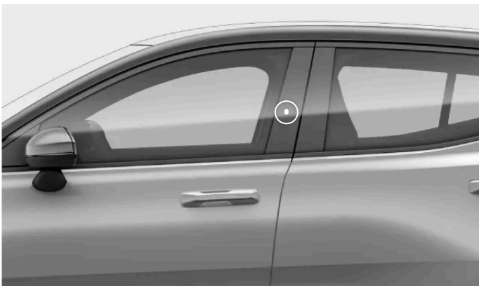
Avaimen lukukohta kuljettajan ovipilarissa
