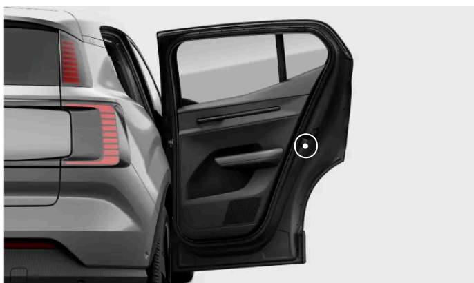
Lapsilukon kytkimen sijainti.
