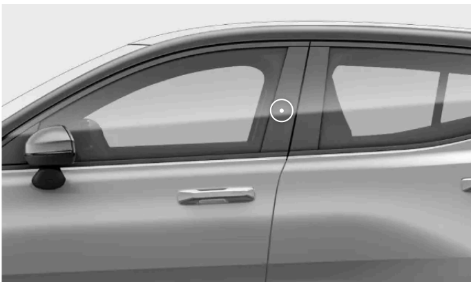
Avaimen lukupaikka kuljettajan ovipilarissa
