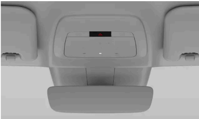
Varoitusvilkkujen painikkeen sijainti kattokonsolissa.
