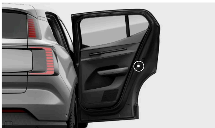
Lapsilukon kytkimen sijainti
