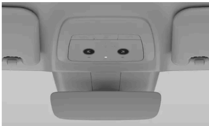
Etuistuintien lukuvalot kattokonsolissa
