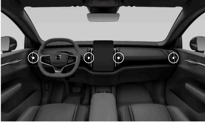
Säädettävien tuuletussuulakkeiden sijainnit.
