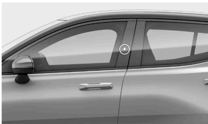
Avaimen lukupaikka kuljettajan ovipilarissa
