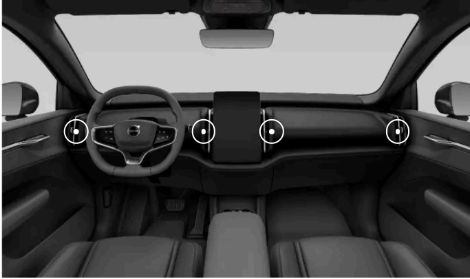
Säädettävien tuuletussuulakkeiden sijainnit.
