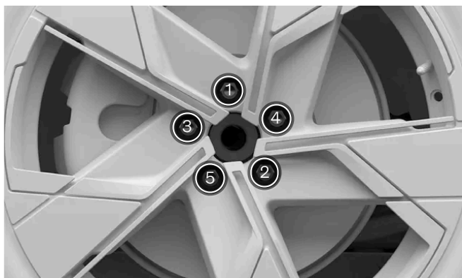
Kiristä pyörän kiinnittimet ristikkäin.
