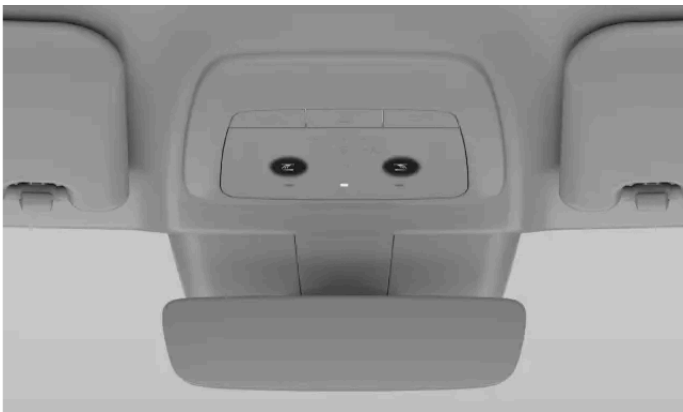
Etuistuimien lukuvalot kattokonsolissa
