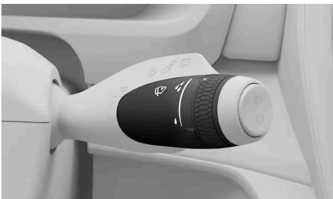
Tuulilasinpyyhkimien säätimet ovat ohjauspyörän oikeanpuoleisessa vivussa.
