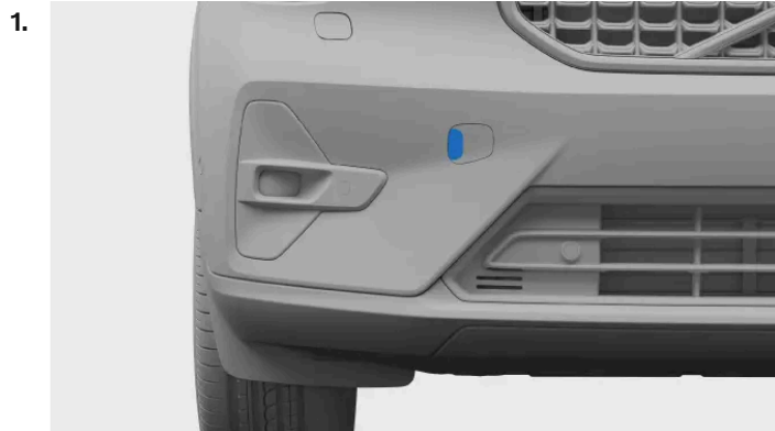
Hinaussilmukan etukiinnityksen suojus
