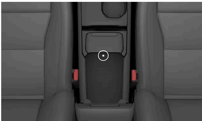
Varalukijan sijainti tunnelikonsolin säilytyslokerossa
