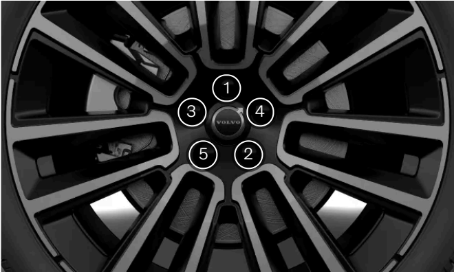
Kiristä pyörän kiinnittimet ristikkäin.
