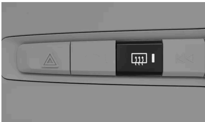
Takahuurteenpoistopainike keskinäytön alapuolella olevassa painikepaneelissa.
