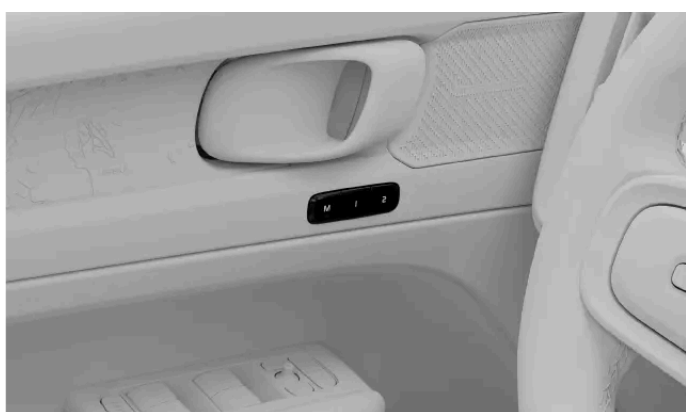
Istuimen esiasetuspainikkeiden sijainti
