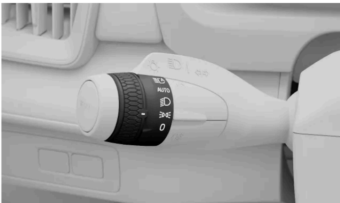
Seisontavalojen symboli vasemmanpuoleisen vivun kiertorengaassa.
