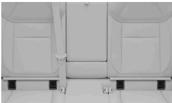
Takaistuimen ISOFIX-kiinnityspisteiden sijainnit
