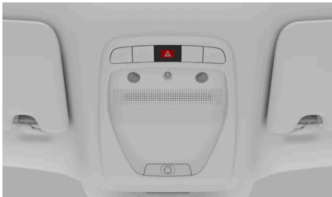
Varoitusvilkkujen painikkeen sijainti kattokonsolissa.
