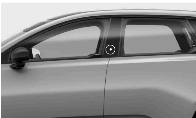
Avaimen lukupaikka kuljettajan ovipilarissa
