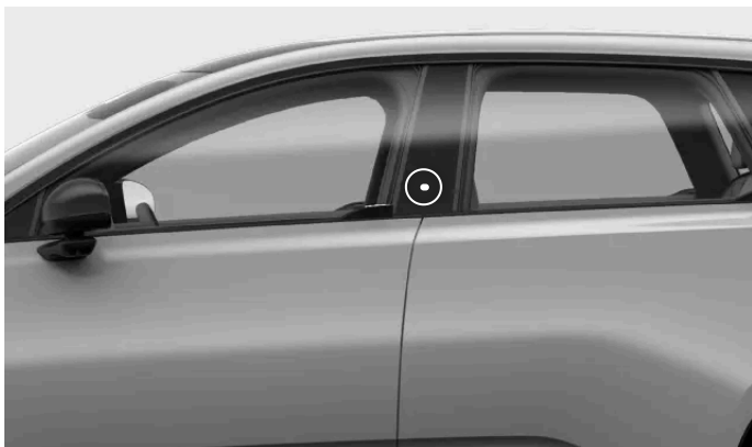
Avaimen lukupaikka kuljettajan ovipilarissa
