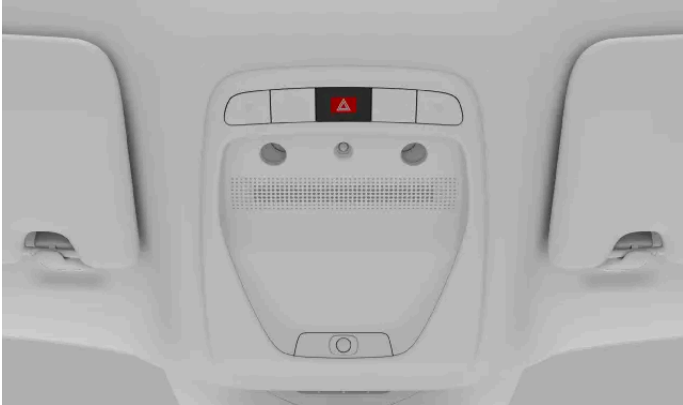
Varoitusvilkkujen painikkeen sijainti kattokonsolissa.
