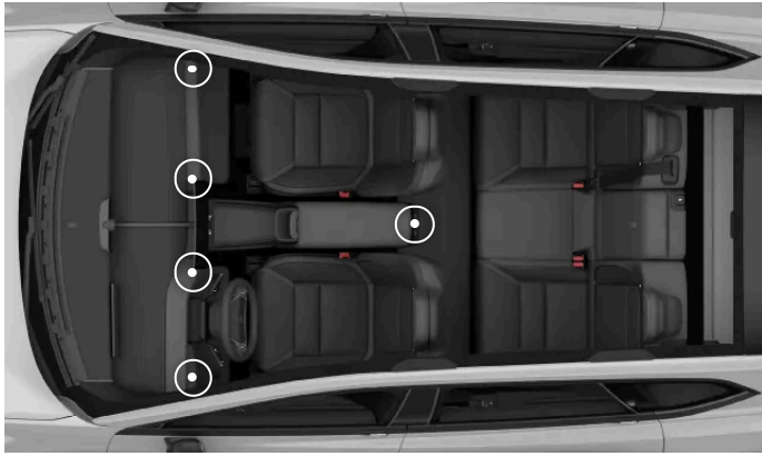
Matkustamon säädettävien tuuletussuutinten sijainnit.
