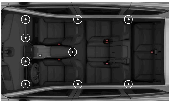
Säädettävien tuuletussuulakkeiden sijainnit
