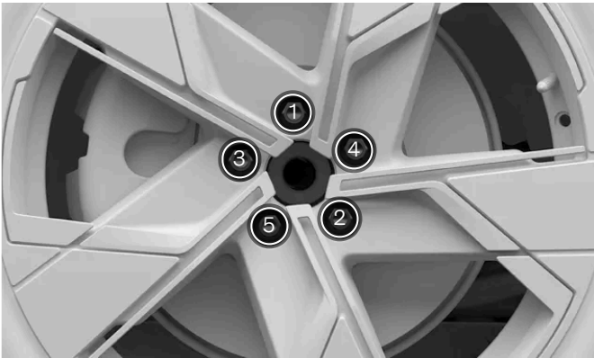
Kiristä pyörän kiinnittimet ristikkäin.
