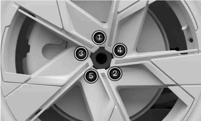
Kiristä pyörän kiinnittimet ristikkäin.
