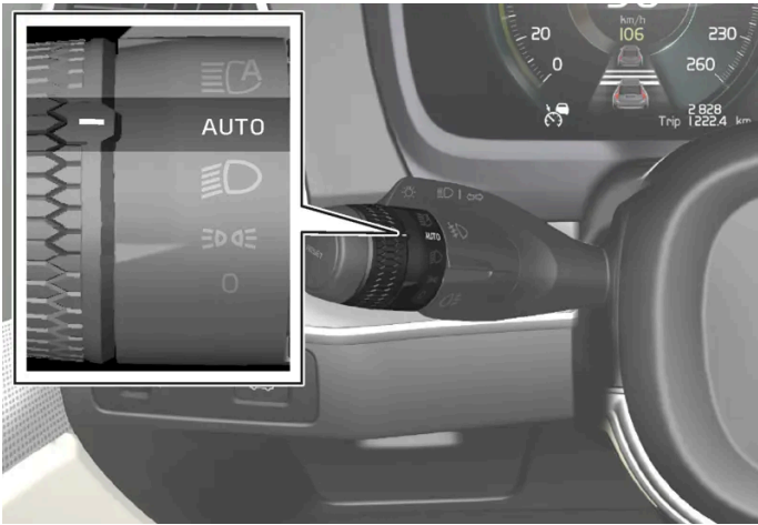
Ohjauspylvään vivun kiertorengas asennossa AUTO.
