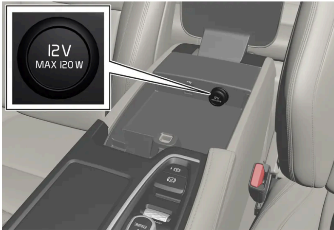
12 V:n sähköliitانتä tunnelikonsolissa, etuistuin.
