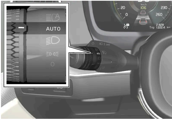
Ohjauspylvään vivun kiertorengas asennossa AUTO.
