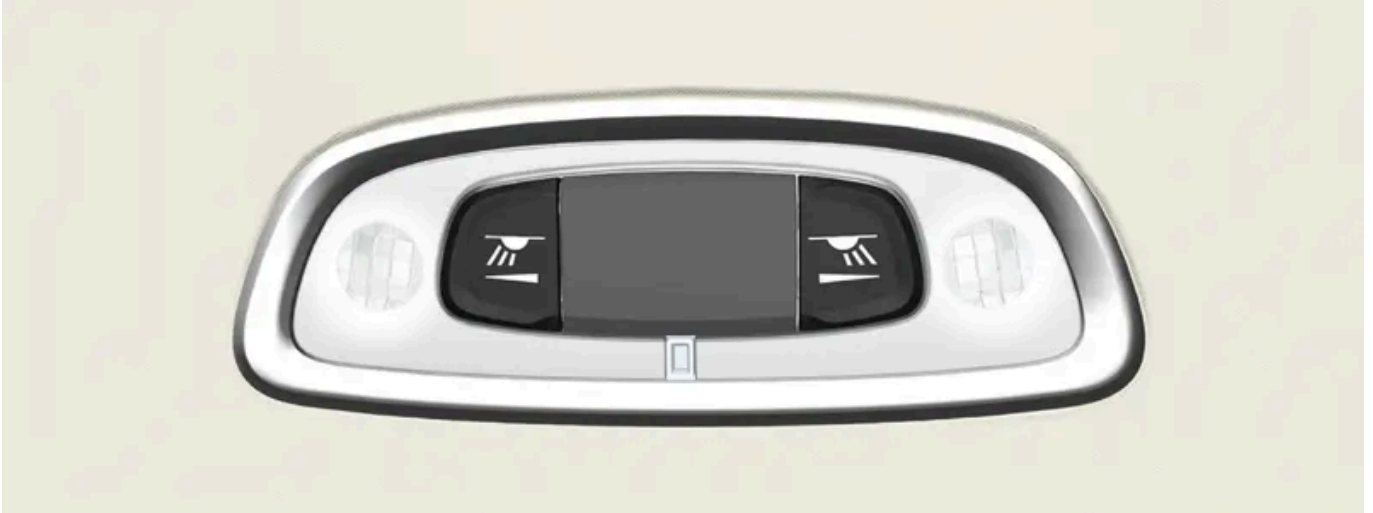
Lukuvalot takaistuimen yläpuolella.
