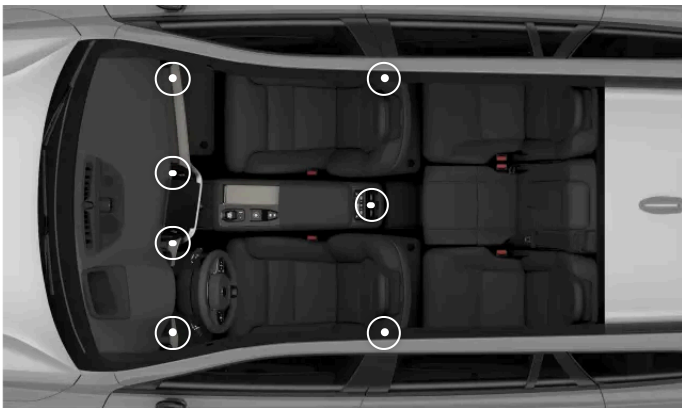
Säädettävien tuuletussuulakkeiden sijainnit
