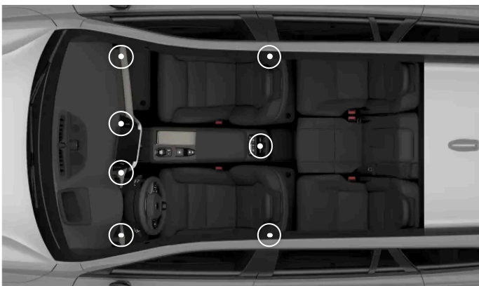
Säädettävien tuuletussuulakkeiden sijainnit
