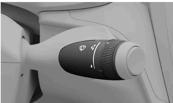
Tuulilasinpyyhkimien säätimet ovat ohjauspyörän oikeanpuoleisessa vivussa.
