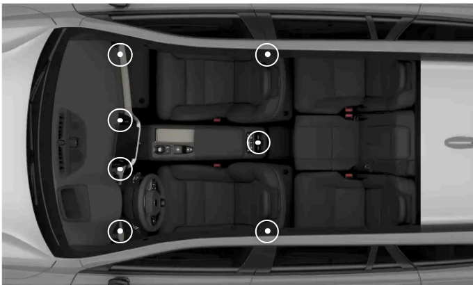
Säädettävien tuuletussuulakkeiden sijainnit
