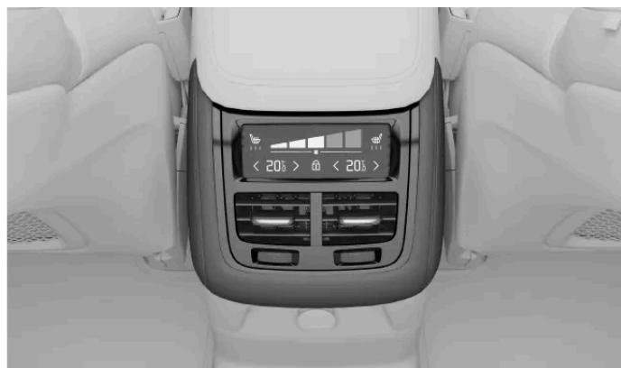
Tunnelikonsolissa olevat ilmastoinnin säätimet
