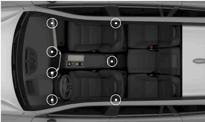
Säädettävien tuuletussuulakkeiden sijainnit
