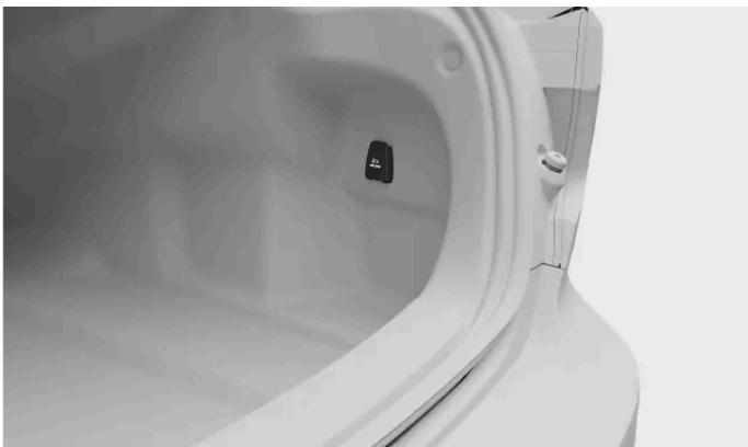
12 V:n pistorasia tavaratilan oikealla puolella.
