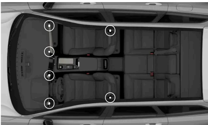
Säädettävien tuuletussuulakkeiden sijainnit
