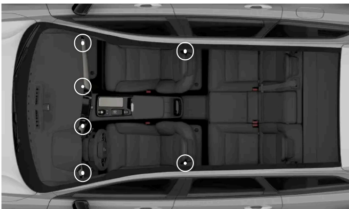
Säädettävien tuuletussuulakkeiden sijainnit
