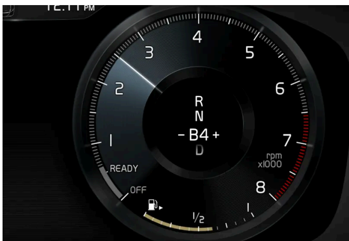
Kuljettajan näyttö vaihdettaessa ohjauspyörävalitsimilla käsinvaihtoasennossa.
