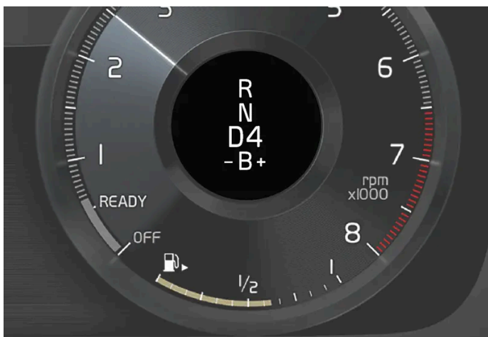
Kuljettajan näyttö vaihdettaessa ohjauspyörävalitsimilla.
