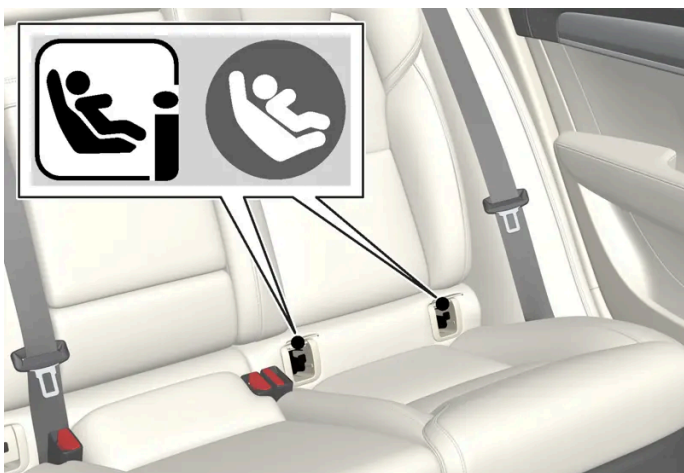
Takaistuimen kiinnityskohtien sijainti osoitetaan symboleilla [1] selkänojan verhoilussa.
