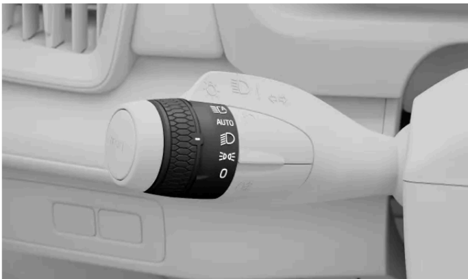
Lähivalojen symboli vasemmanpuoleisen vivun kiertorenkaassa.
