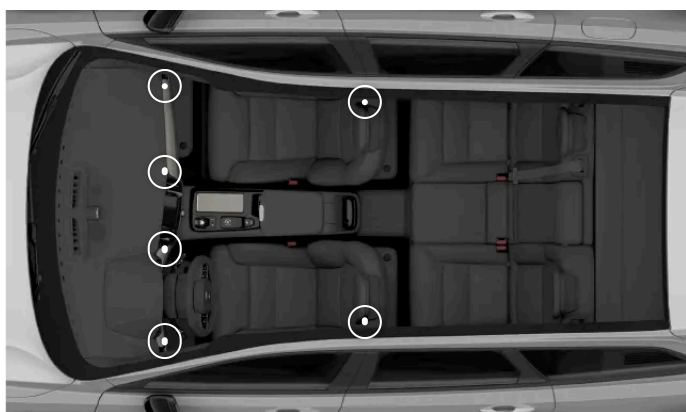
Säädettävien tuuletussuulakkeiden sijainnit
