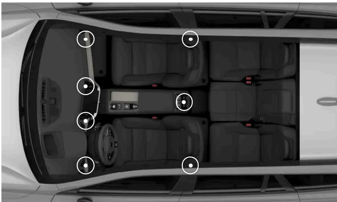
Säädettävien tuuletussuulakkeiden sijainnit
