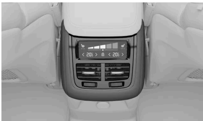
Tunnelikonsolissa olevat ilmastoinnin säätimet
