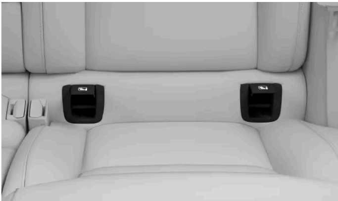
Ulompien takaistuimen ISOFIX-kiinnityspisteiden sijainnit
