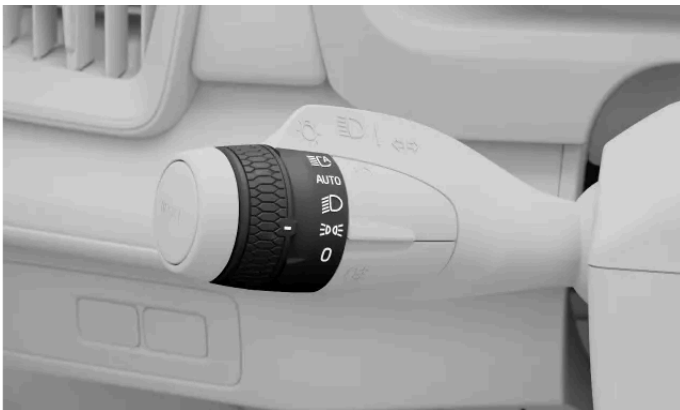
Seisontavalojen symboli vasemmanpuoleisen vivun kiertorengaassa.
