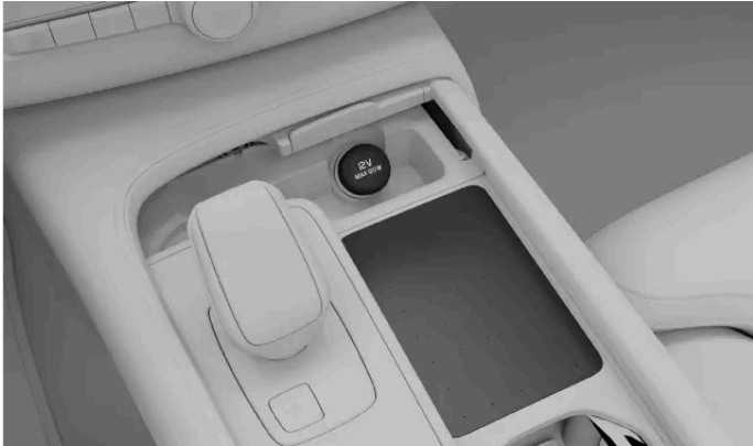
12 V:n pistorasia tunnelikonsolissa
