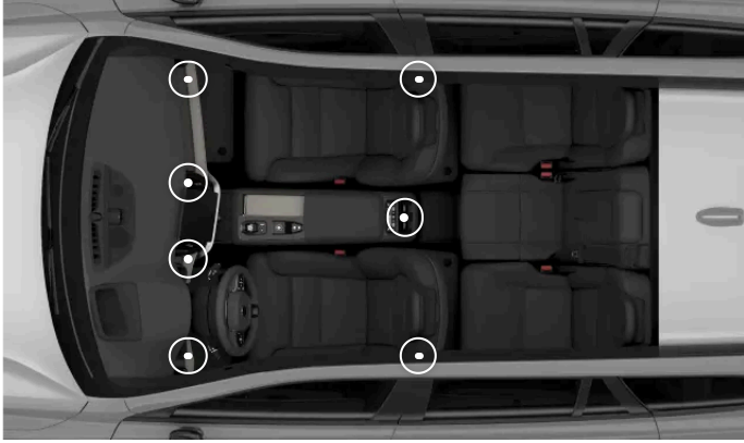
Säädettävien tuuletussuulakkeiden sijainnit
