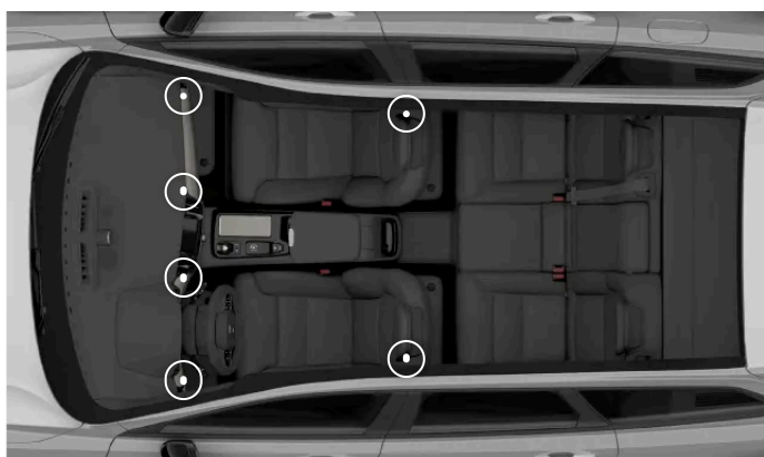
Säädettävien tuuletussuulakkeiden sijainnit
