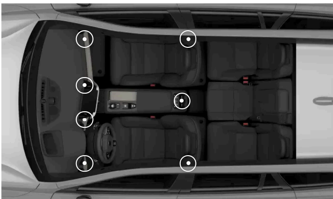
Säädettävien tuuletussuulakkeiden sijainnit
