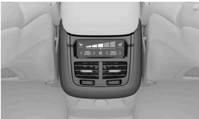
Tunnelikonsolissa olevat ilmastoinnin säätimet
