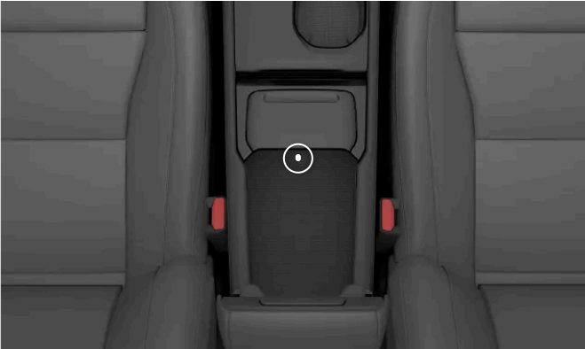
Varalukijan sijainti tunnelikonsolin säilytyslokerossa
