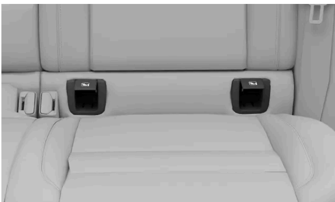
Uloimpien takaistuimen ISOFIX-kiinnityspisteiden sijainnit
