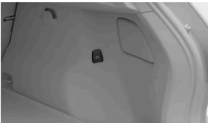
12 V:n pistorasia tavaratilan oikealla puolella.
