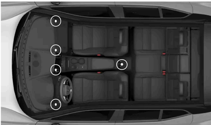
Säädettävien tuuletussuulakkeiden sijainnit
