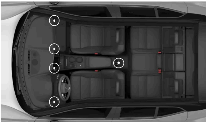
Säädettävien tuuletussuulakkeiden sijainnit
