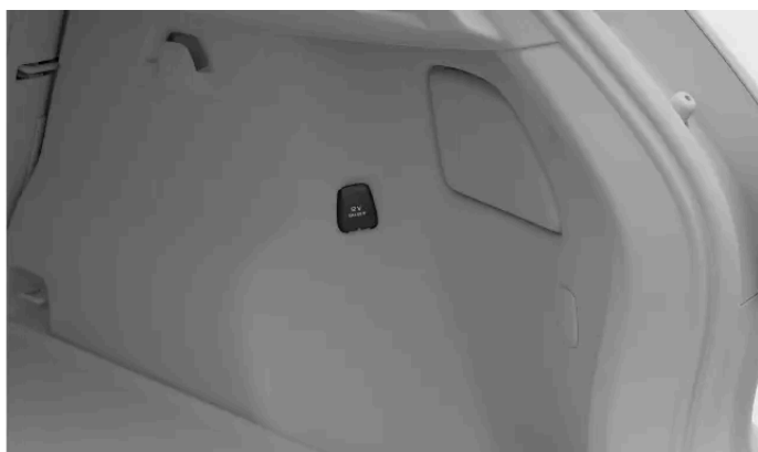
12 V:n pistorasia tavaratilan oikealla puolella.
