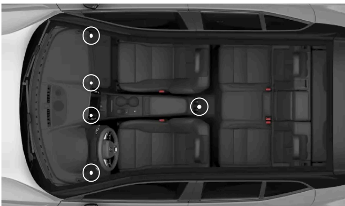
Säädettävien tuuletussuulakkeiden sijainnit
