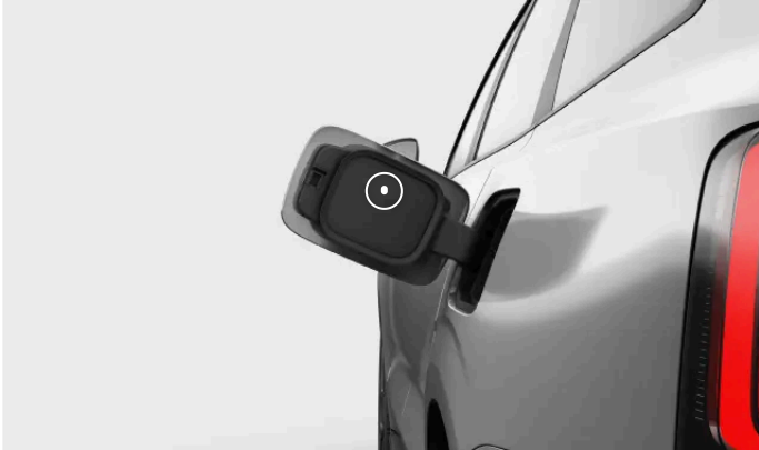
Tunnistetarra sijaitsee latauskannen sisäpuolella.
