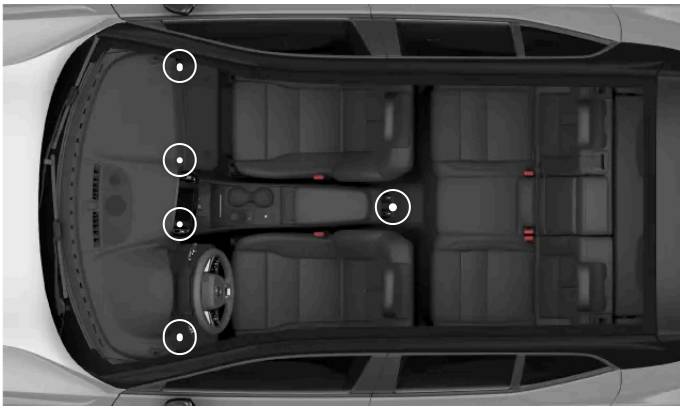
Säädettävien tuuletussuulakkeiden sijainnit
