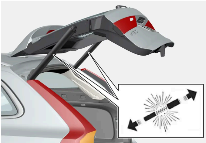
Sähkötoimisen takaluukun esijännitetyt jouset.
