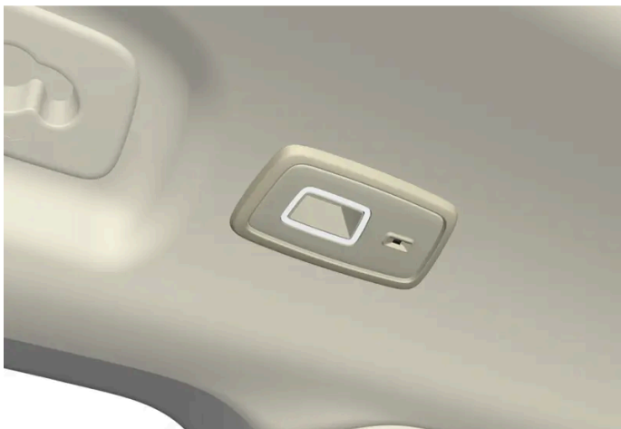
Panoraamakaton* varustetussa autossa on kaksi valoyksikköä katon kummallakin puolella.
